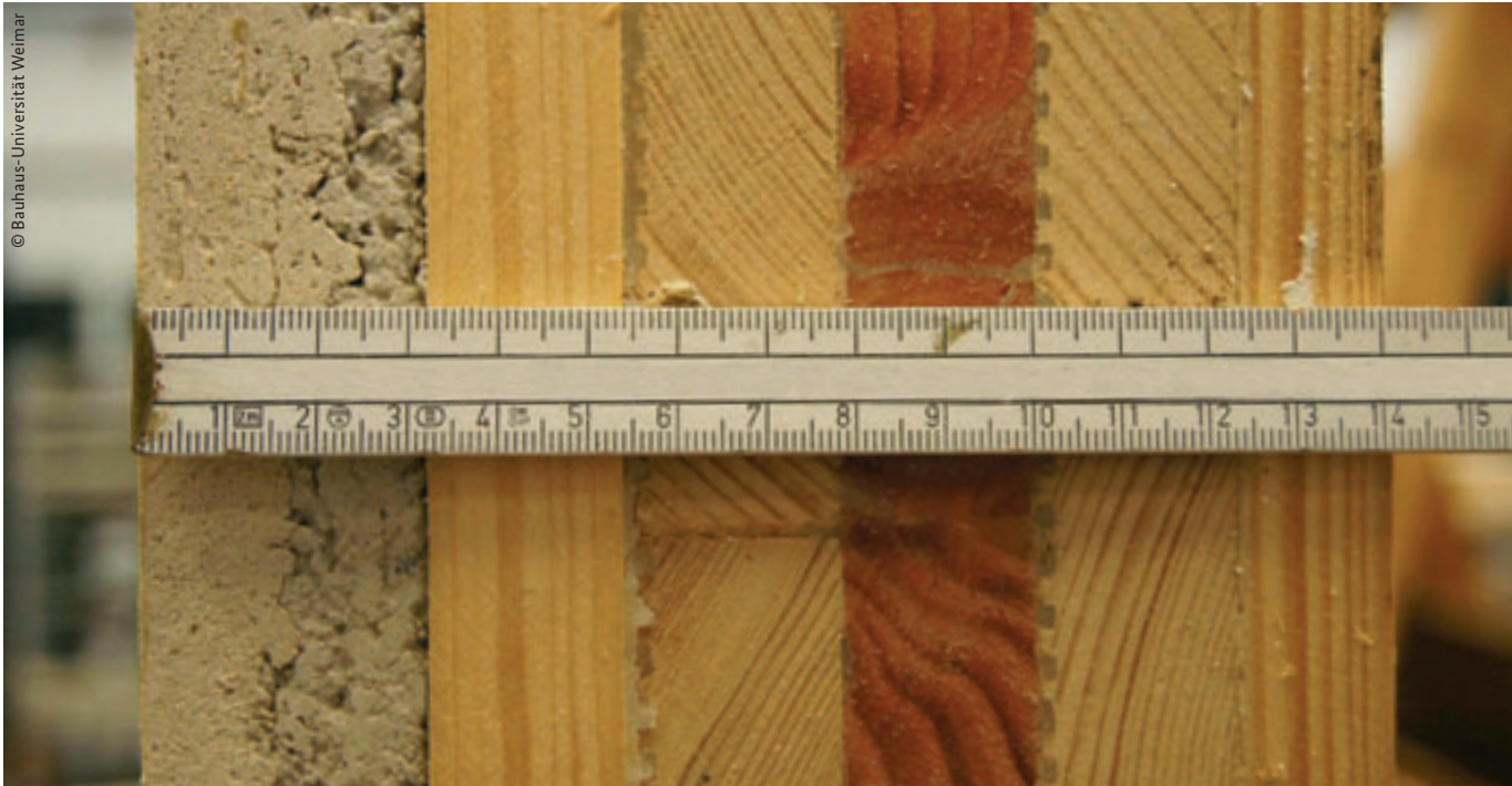
Äußerst belastbar und gut fürs Raumklima: Für die Holz-Anhydrit-Verbundsysteme der Bauingenieure an der Bauhaus-Universität Weimar wird das gipsähnliche Anhydrit direkt auf Holz aufgetragen.
