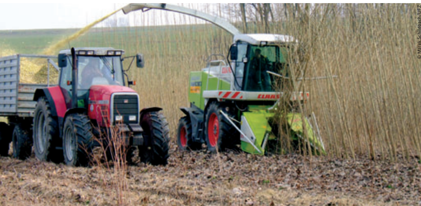
Pappel-Ernte in einer Kurzumtriebsplantage: Nach drei Jahren Dauerkultur werden die Baumstämme abgeschnitten und zerknispelt.
